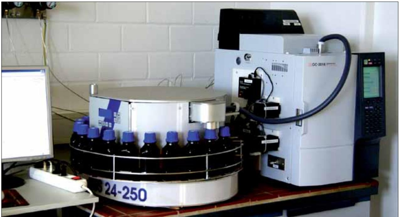
Bild 3. Autosampler-GC-Kopplung mit EGS-Flaschen
