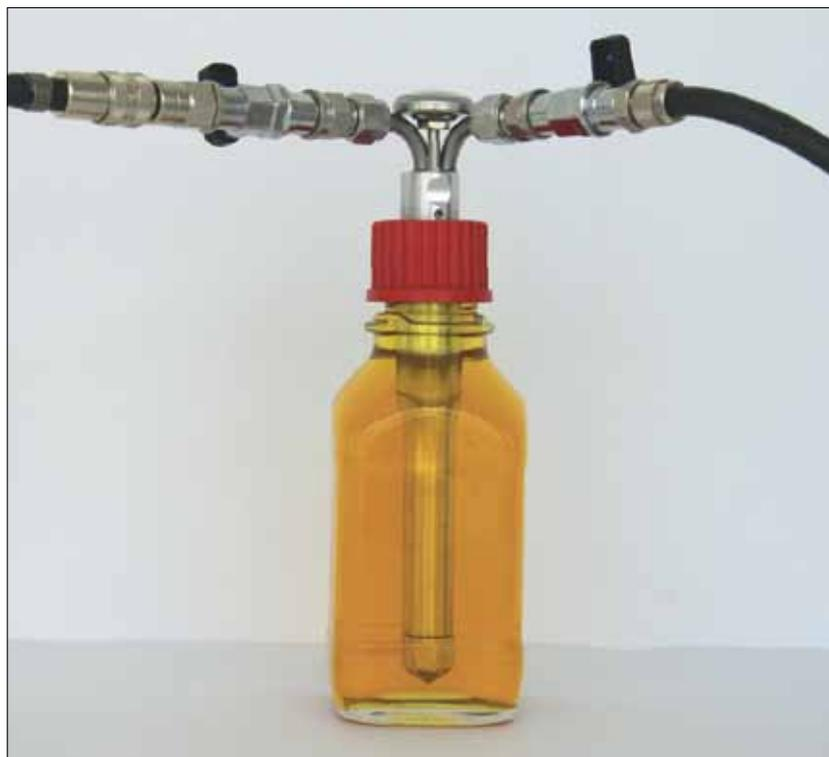
*Bild 1. Gefüllte Flasche mit Füllstutzen sowie Zu- und Ablaufschlauch*
